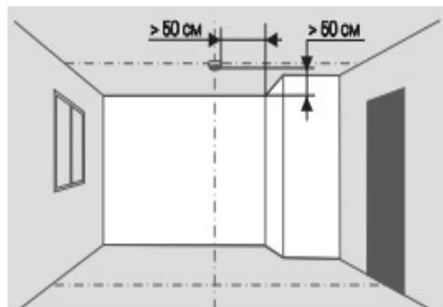
Монтируются АПИ на открытом потолочном пространстве с хорошей циркуляцией воздуха. Не рекомендуется установка над дверьми и в отдаленных углах помещения. Также не желательно попадание на автономный извещатель прямых солнечных лучей. Мигающий сигнал светодиода красного цвета, расположенного на корпусе АПИ, свидетельствует о его исправности и нахождении в дежурном режиме работы.
